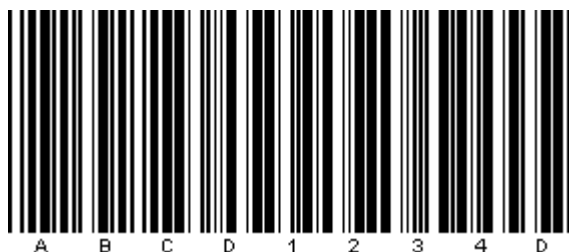
Code 39 avec un chiffre de contrôle affiché dans la zone de texte
